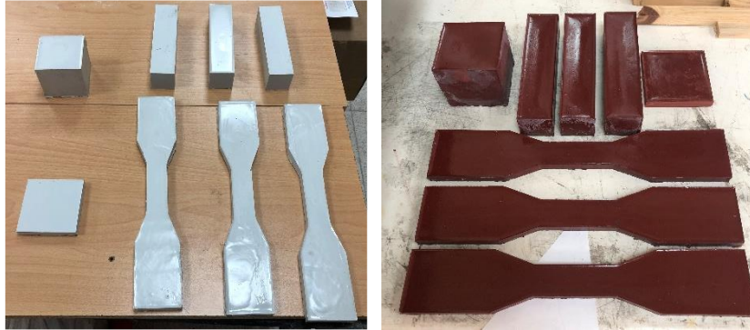
Şekil 4. Üretilen polimer beton numunelerinden örnekler.
