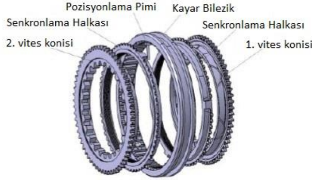
Şekil 19. Senkromeci oluşturan eleman grubu (Sorniotti ve diğerleri, 2011)
