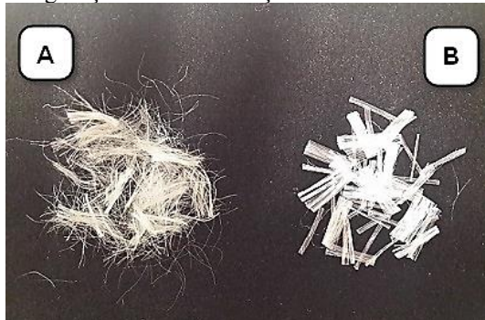
Şekil 2. Monofilament (A) ve fibrile (B) life ait fotoğraf.
