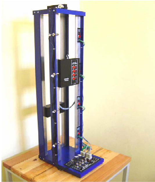
Şekil 3. Üç katlı asansör sisteminin genel görünümü.
