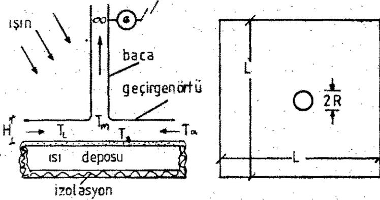
Şekil-1: Güneş enerjisi konveksiyon bacasının yandan ve üstten görünüşleri
