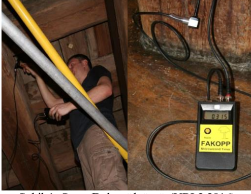
Şekil 1. Stres Dalga ölçümü (URL2,2016).
