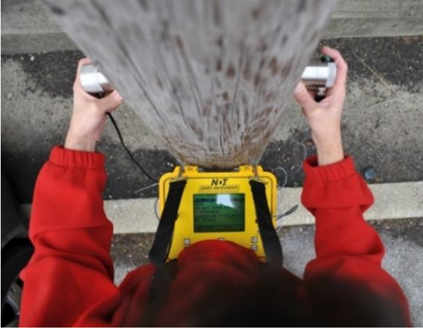
Şekil 3. Ultrasonik yöntemle ölçüm (URL1, 2015)
