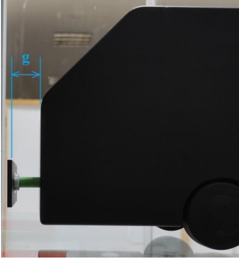
Şekil 4. Ön kısmına belirli bir boşlukla (g) plaka yerleştirilmiş otobüs modeli
