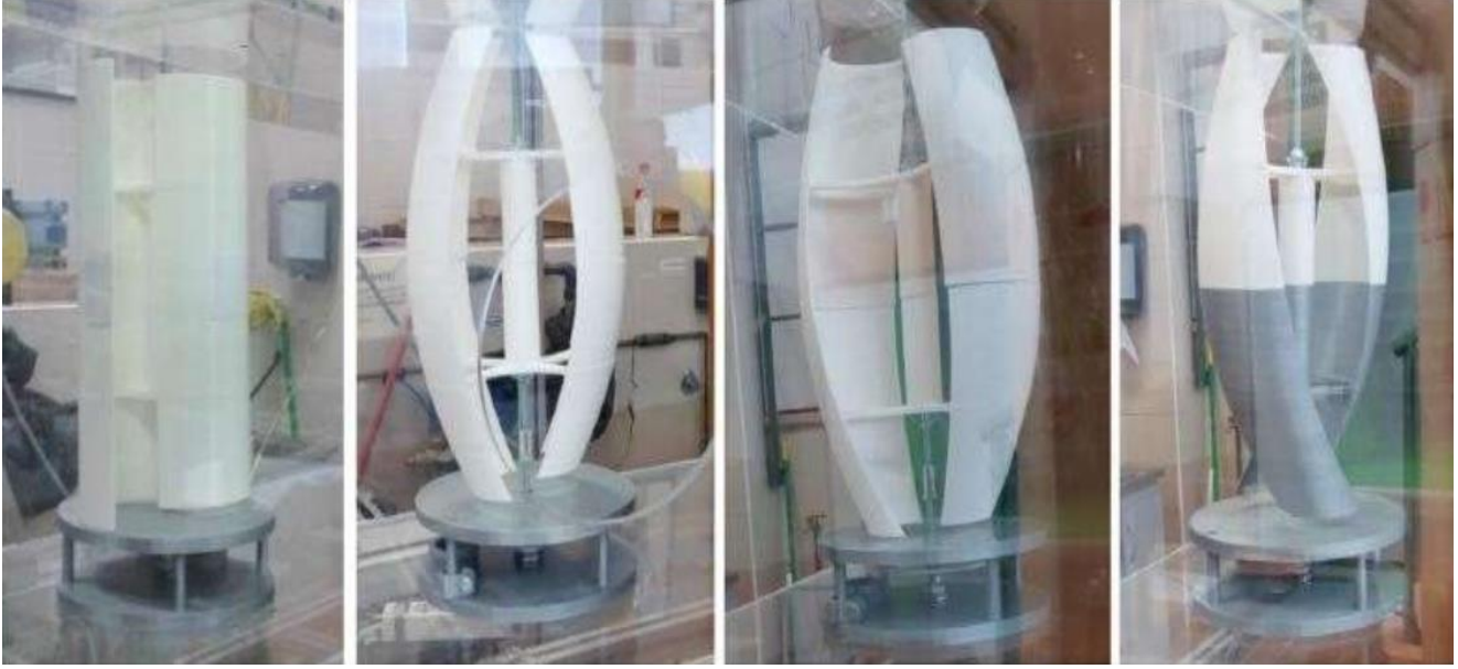
Şekil 4. Klasik Savonius rotoru ve 0°, 22.5°, 45° burulma açılarında modifiye edilmiş Savonius türbinleri (Mercado-Colmenero ve ark., 2018)
