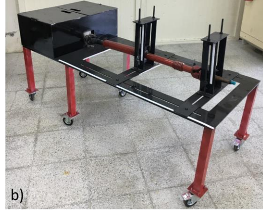
Şekil 2. Üç kardan mafsallı tahrik iletim hattı test düzeneğinin a) tasarımı ve b) üretilmiş son hali
