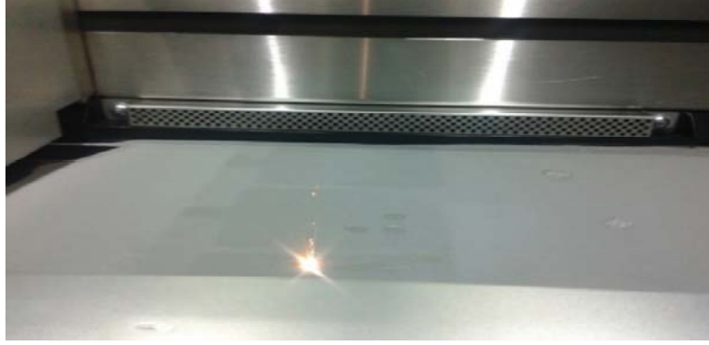
Şekil 5. DMLS cihazında ilk katman toz malzeminin serilmesi
