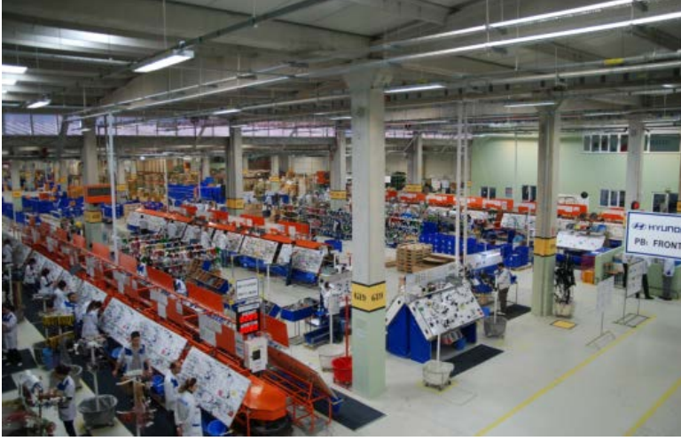
Şekil 2. Kablo donanım üretiminde kullanılan konveyör hatları (Fabrikadan genel bir görünüş)
