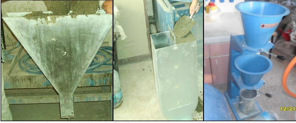
Şekil 1. Çalışmada kullanılan V kutusu, U kutusu ve sıkıştırma faktörü deney aletleri
