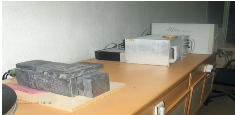
Şekil 2. Ölçüm sistemi (NaI(Tl) detektörü, çok kanallı analizör)
