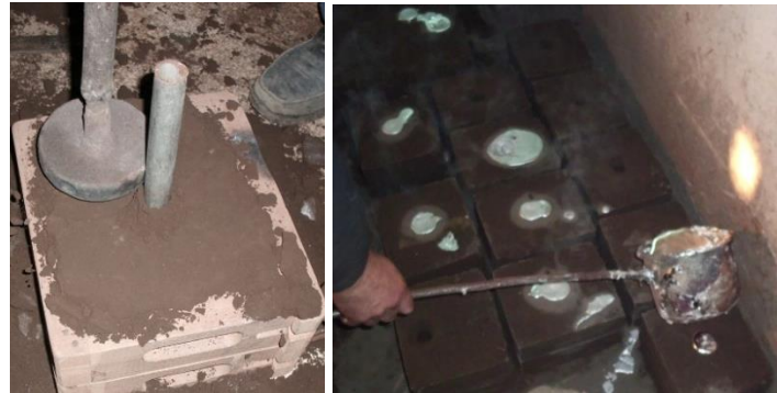
Şekil 13. Yolluk açma ve döküm işlemi
