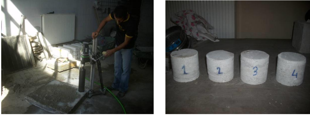
Şekil 3. Panelden Karot Alımı ve Karotların Genel Görünümü
