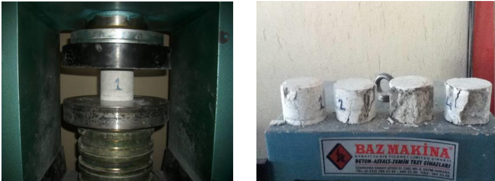
Şekil 4. Karot Numunelerinin Basınç Deneyi ve Sonrasındaki Görünümü
