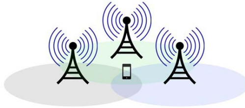
Şekil 1. Çoklu baz istasyonu gsm ağı konum tespiti
