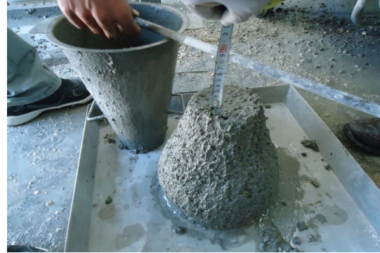
Şekil 2.6. Çökme değerinin belirlenmesi
