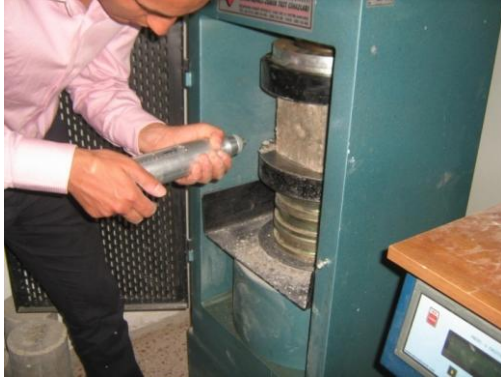
Şekil 1. Küp Numunelere Schmidt ve Ultrases Deneylerinin Yapılması
