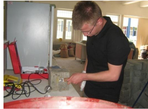
Şekil 1. Küp Numunelere Schmidt ve Ultrases Deneylerinin Yapılması
