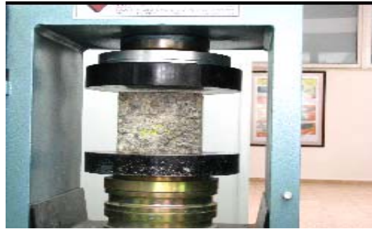
Fotoğraf 5. Basınç Testi
