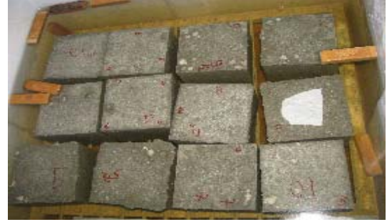
Fotoğraf 4. Numunelere Kür Uygulanması
