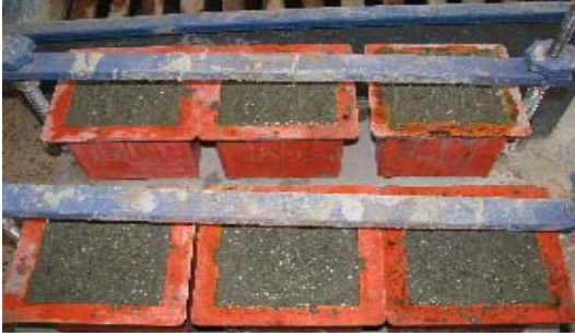
Fotoğraf 3. Numunelerin Kalıplara Dökümü
