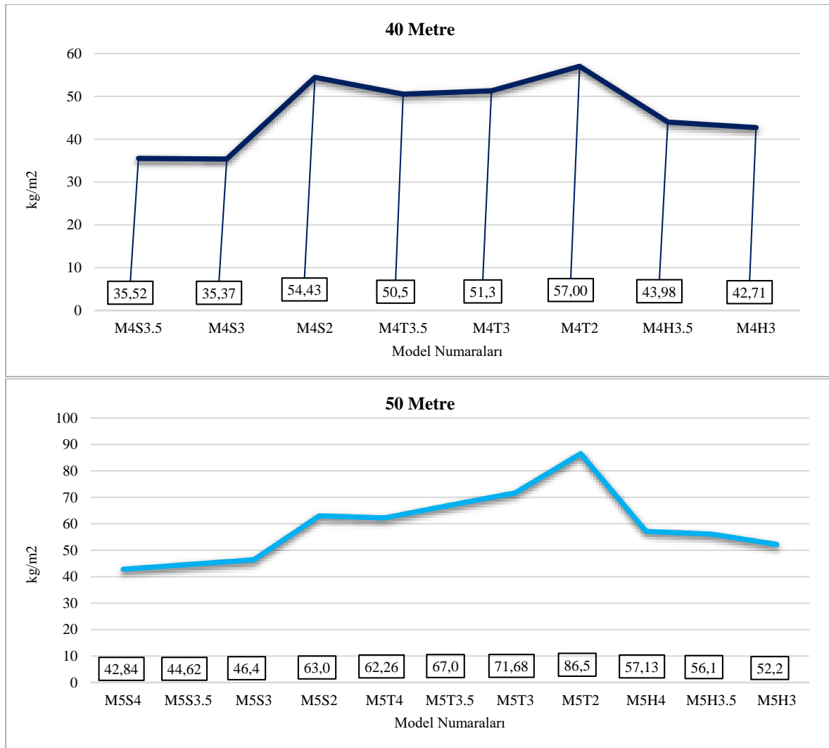
Şekil 12. 40 ve 50 metre açıklık için oluşturulan modellerin kg/m 2 cinsinden ağırlık karşılaştırılması
