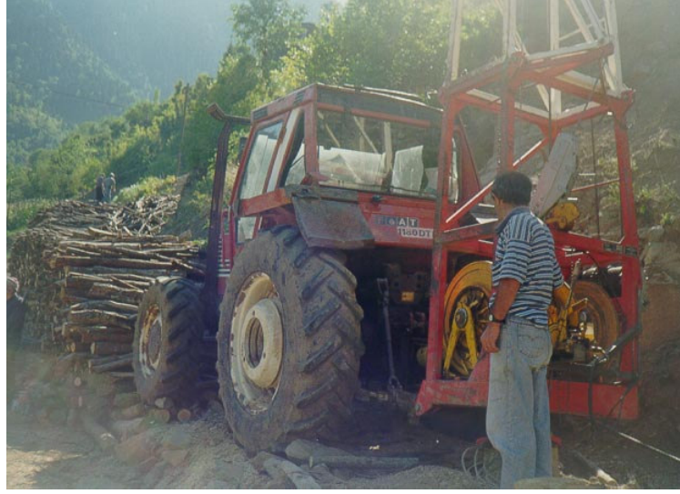
Şekil 1. Çukur üretim alanındaki Koller K300 hava hattı (Foto: ÖZTÜRK)
