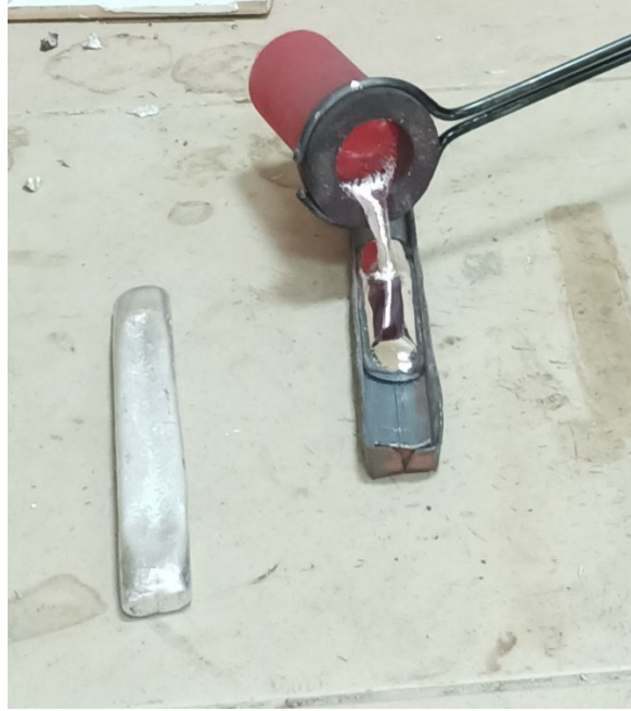
Şekil 4. Dökümü yapılan alüminyumun oda koşullarında soğuması
