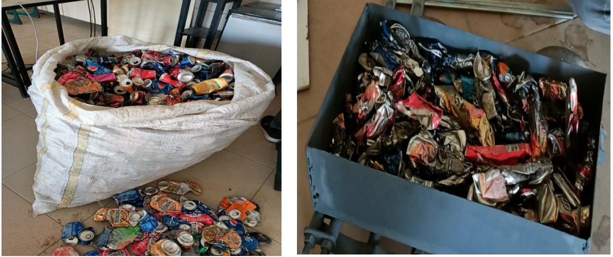
Şekil 1. Atık alüminyumların temin edilerek ezilmesi
