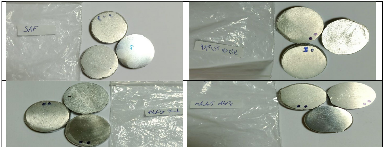
Şekil 6. Isı iletkenliği ölçülen Al_2O_3 numuneler
