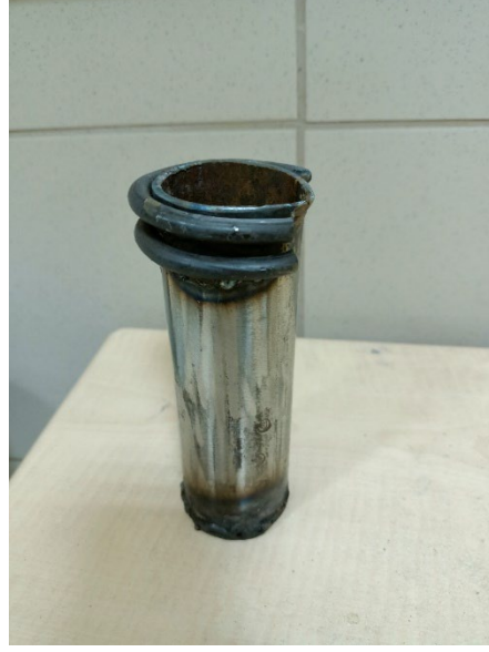
Şekil 3. Paslanmaz çelikten imal edilen ergitme potası
