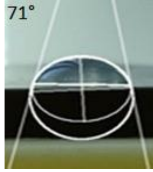
Şekil 3. ABSP uygulaması öncesi PP malzeme üzerindeki su temas açısının ImageJ yazılımı ile ölçümü
