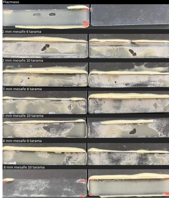
Şekil 5. Farklı işlem mesafeleri ve tarama sayılarında ABSP uygulanan PP numunelerinin çekme testleri sonrası ayrılma yüzey fotoğrafları
