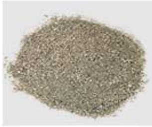
Şekil 1. Beton karışımlarında kullanılan 0-4 mm dane aralığındaki pomzanın görünümü
