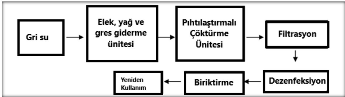
Şekil 2. Gri suyun geleneksel yöntemlerle arıtılması için akış şeması
