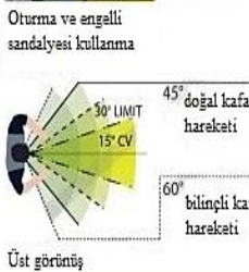
Şekil 5: Ayakta, oturan ve engelli birey için görüş alanı ölçütleri (Url-13)
