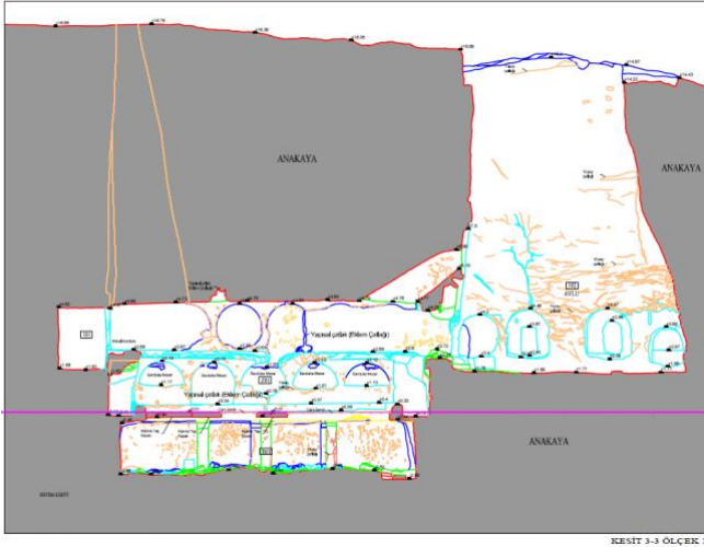
Şekil 14. 3-3 Kesiti'nde taş malzeme bozulmaları
