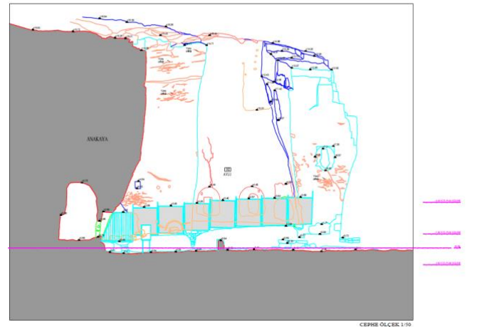
Şekil 18. Cephe üzerindeki taş malzeme bozulmaları
