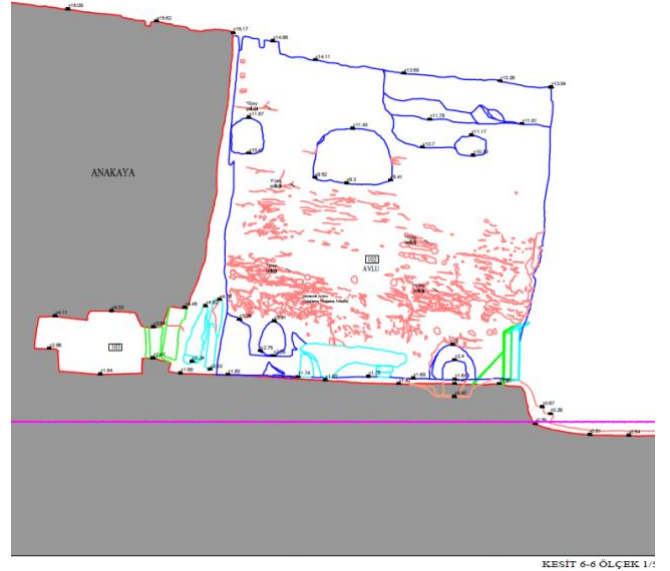
Şekil 17. 6-6 Kesiti'nde taş malzeme bozulmaları
