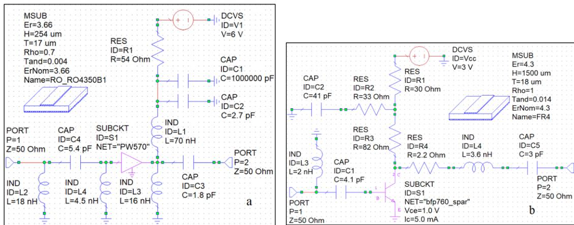
**Figure 2. a. PA circuit b. LNA circuit.**
