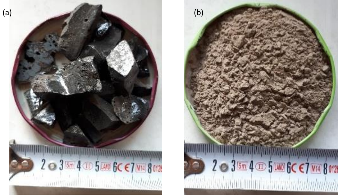
Şekil 1. (a)Granüle yüksek fırın cürufu b)Granüle yüksek fırın cürufunun -63 µm boyutuna öğütülmüş hali.
