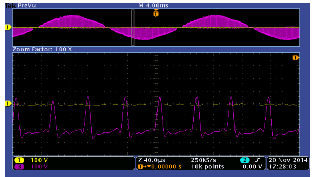
Şekil 22: Gerilim çökmesi durumu, tam yük, negatif çevrim DGM anahtarlaması
