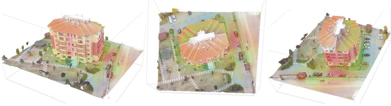
Şekil 15. Füzyonu gerçekleştirilmiş katı modelin farklı açılardan gösterimi
