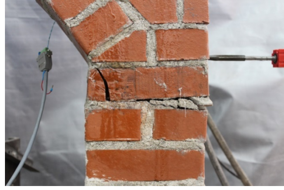
Şekil 11. Model-4 numunesi göçme anı hasarları (The failure mechanism of Model-4)
