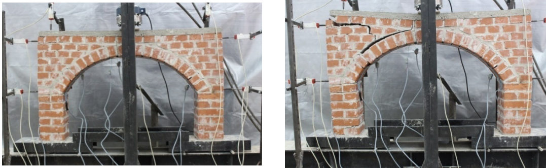
Şekil 9. Model-3 numunesinin deney öncesi ve göçme anındaki fotoğrafları (The photo of Model-3 specimen and failure mechanism developed)
