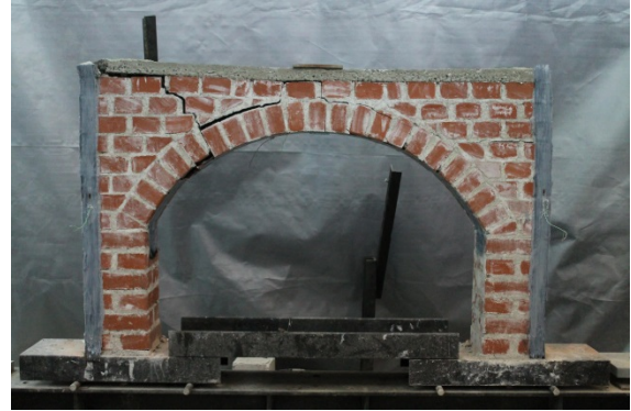
Şekil 13. Model-6 numunesinin deney öncesi ve göçme anındaki fotoğrafları (The photo of Model-6 specimen and failure mechanism developed )
