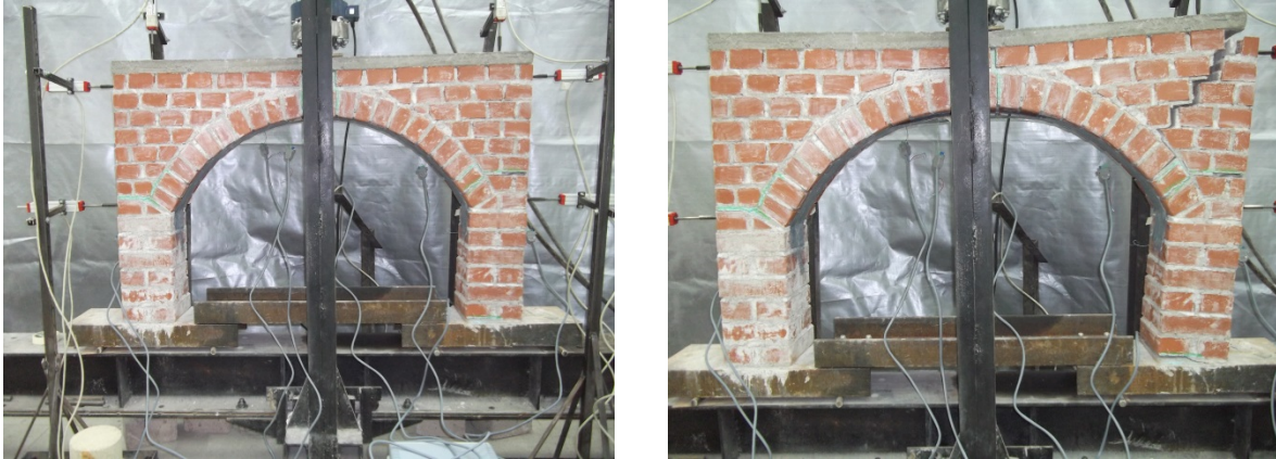
Şekil 6. Model-1 numunesinin deney öncesi ve göçme anındaki fotoğrafları (The photo of Model-1 specimen and failure mechanism developed)
