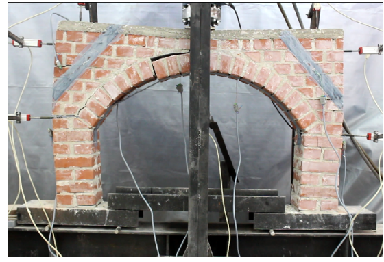
Şekil 12. Model-5 numunesinin deney öncesi ve göçme anındaki fotoğrafları (The photo of Model-5 specimen and failure mechanism developed )
