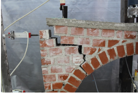
Şekil 11. Model-4 numunesi göçme anı hasarları (The failure mechanism of Model-4)
