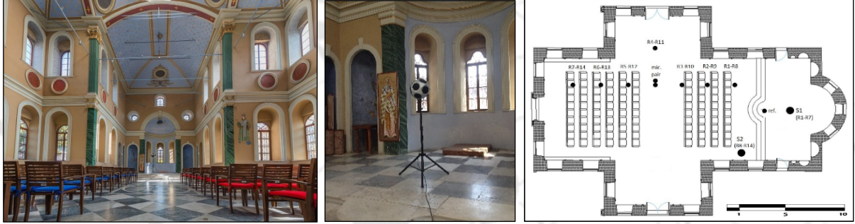
Resim 3. Girişten apsis (sol), B&K 2270 kaynak (S1), kaynak ve alıcı noktaları (sağ)
