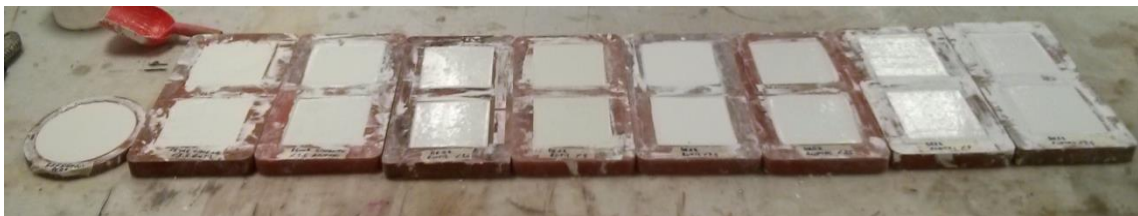
Şekil 7: Kalıplara dökülen numuneler
