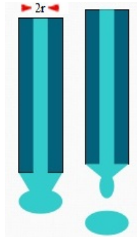
Şekil 6. Damla ağırlığı yöntemi ile yüzey geriliminin belirlenmesi.
