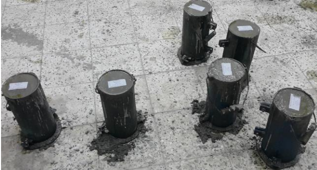
Şekil 1. Kalıplanan silindirik beton numunelerden birkaçı
