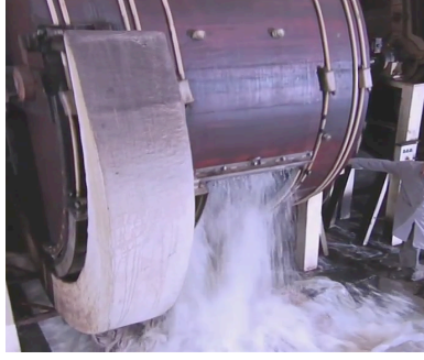
Fotoğraf 18. Derilere uygulanan kireçlik ve sama işlemi(Cevahir deri, 2015)
