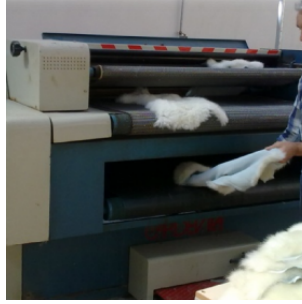
Fotoğraf. 21. Derinin ütüden geçirilmesi (Arinna deri, 2015)
