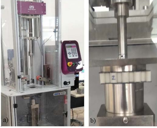
Şekil 5. a) Instron ceast 9350 darbe test cihazı görüntüsü b) Darbe numunesinin test sırasındaki görüntüsü (a) Image of Instron ceast 9350 impact tester b) Image of impact sample during testing
