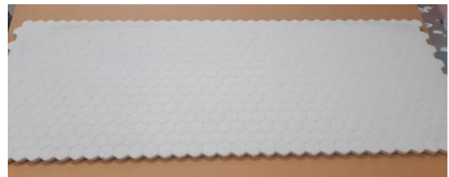
Şekil 1. Sandviç yapı üretiminde kullanılan çekirdek malzeme.
