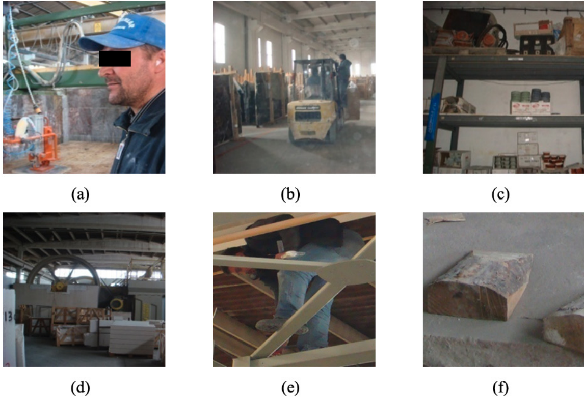
Şekil 2. İşletmede görülen tehlikeli durum ve hareketler a) Çalışanların kişisel koruyucu donanım kulaklık kullanmaması, b) İşletme içerisinde forklift ile insan taşımalarının yapılması, c) Malzeme raflarında yanlış yerleştirme ve raf önlerinde koruyucu bulunmaması, d) Katrak makinesi (mermer kesiminde kullanılan iş ekipmanı)nin koruyucu donanımlarının olmaması, e) Yüksekte çalışmalarda gerekli önlemlerin alınmaması, f) İşletme içerisinde zeminde takılıp düşmeye neden olabilecek tahta parçalarının bulunması
