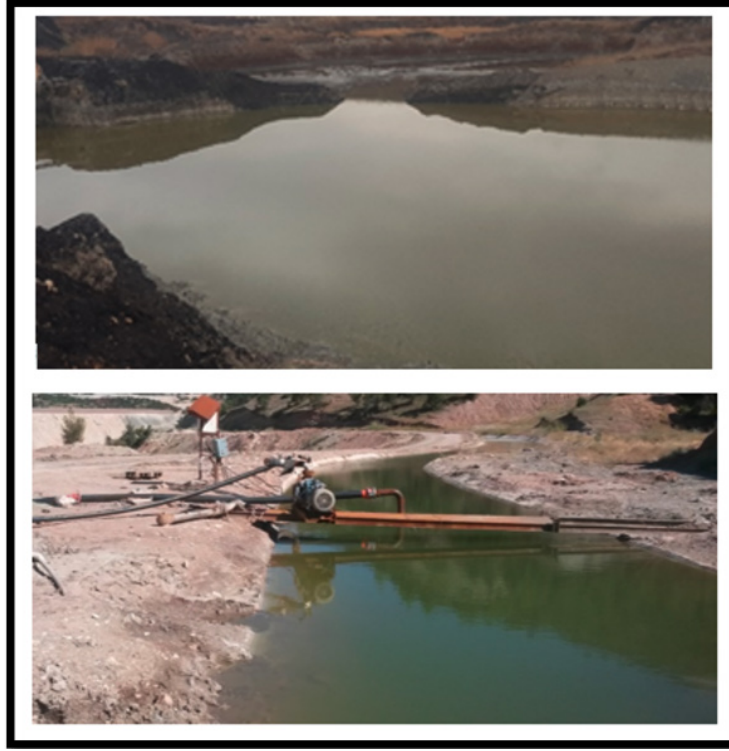
Şekil 5. Ocak içerisinde depolanan fazla suyun depolanması kanal ile drene edilmesi (ETİ, 2016)
