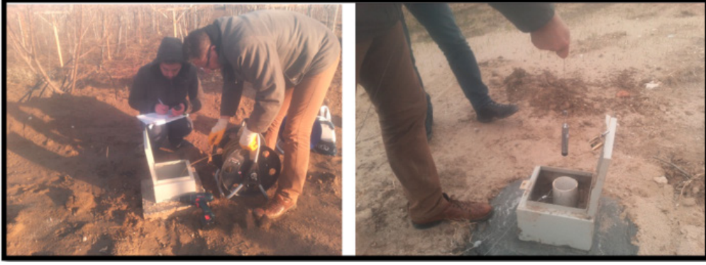
Şekil 10. Pompaj ve gözlem kuyularında debi ve seviyenin izlenmesi
