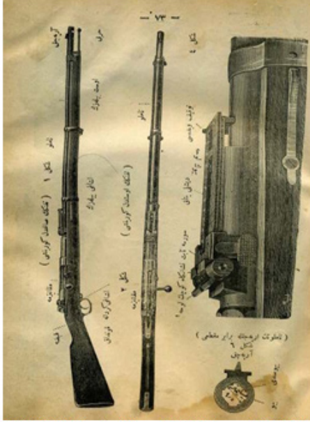
(Şekil 1) (Tüfengin sağdan görünüşü) Arpacık Namlu (Şekil 1) Mekanizma Kabza Harbi Üst Bilezik Aşağı Bilezik Aşağı Gerdâne Kundak (Tüfengin üstten görünüşü) (Şekil 2) Namlu Mekanizma (Şekil 4) Tevkif Vidası Büyük Levha (Ters yazı) Dişli Yatak ..... Sürme Sabit Nişangâh Küçük Levha (Namlumun arpacıkla beraber kat'ı) (Şekil 6) Arpacık Yiv seti Yiv Milimetre 5 / 9
