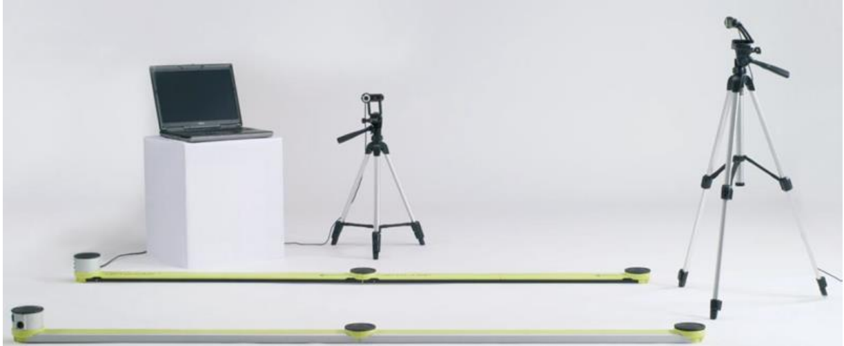
Şekil 4. Optojump fotoelektrik (Microgate Opto Jump Next) sistemi
