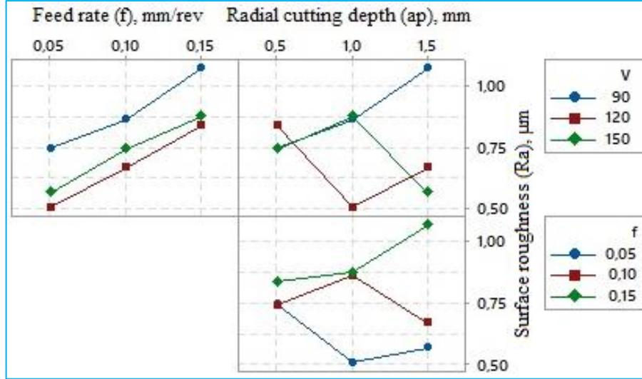
Figure 4. Variation of Ra versus cutting parameters (Kesme parametrelerine karşılık Ra'nın değişimi).
