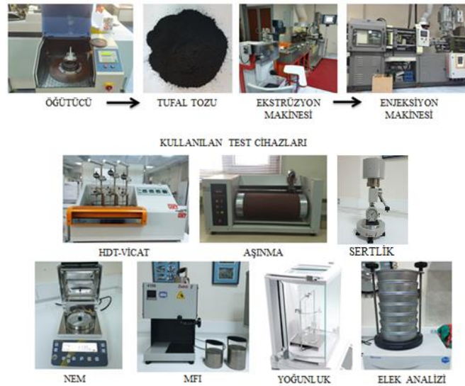
Şekil 3. ABS/çelik tufali polimer kompozitinin üretim aşamaları ve kullanılan cihazlar
