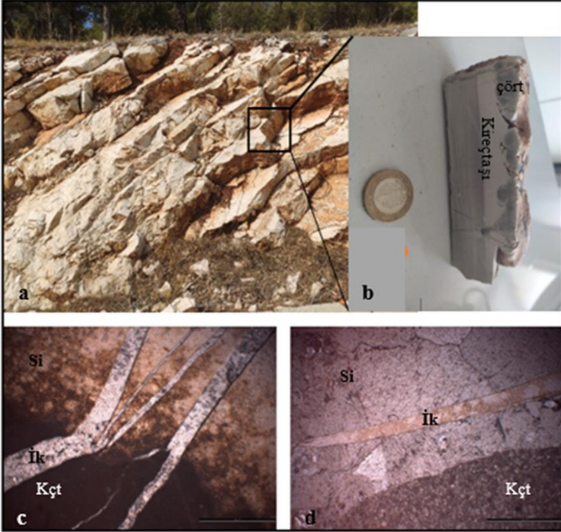
Şekil 12. Şekil 3’de ölçülen sedimentolojik kesitin 15-21. Metre seviyelerindeki B11 kayaç örneğinin saha ve mikroskopik görünümü. Silis ve kireçtaşı geçiş dokanağı, (İk:ikincil silisleşme sonrası gelişen kalsit damarı Si: Silis Kçt: Kireçtaşı).
