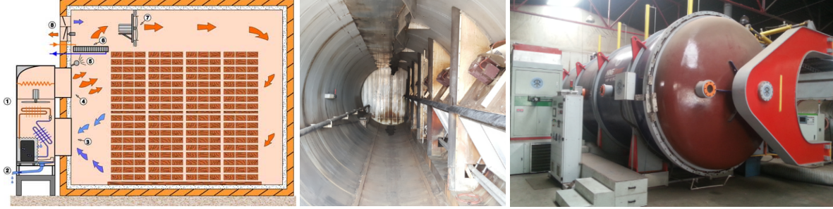
Şekil 2. Kondenzasyon (solda) (Nigos, 2023), vakum (ortada) (Hızır Volkan Görgün, 2017) ve yüksek frekansta elektrik akımıyla ısıtma esaslı (Ünsal vd., 2014: 3) kurutma fırınları (sağda)
