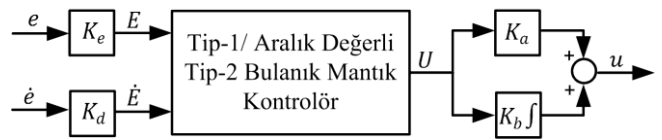
Şekil 1: Bulanık PID kontrolörünün yapısı.
