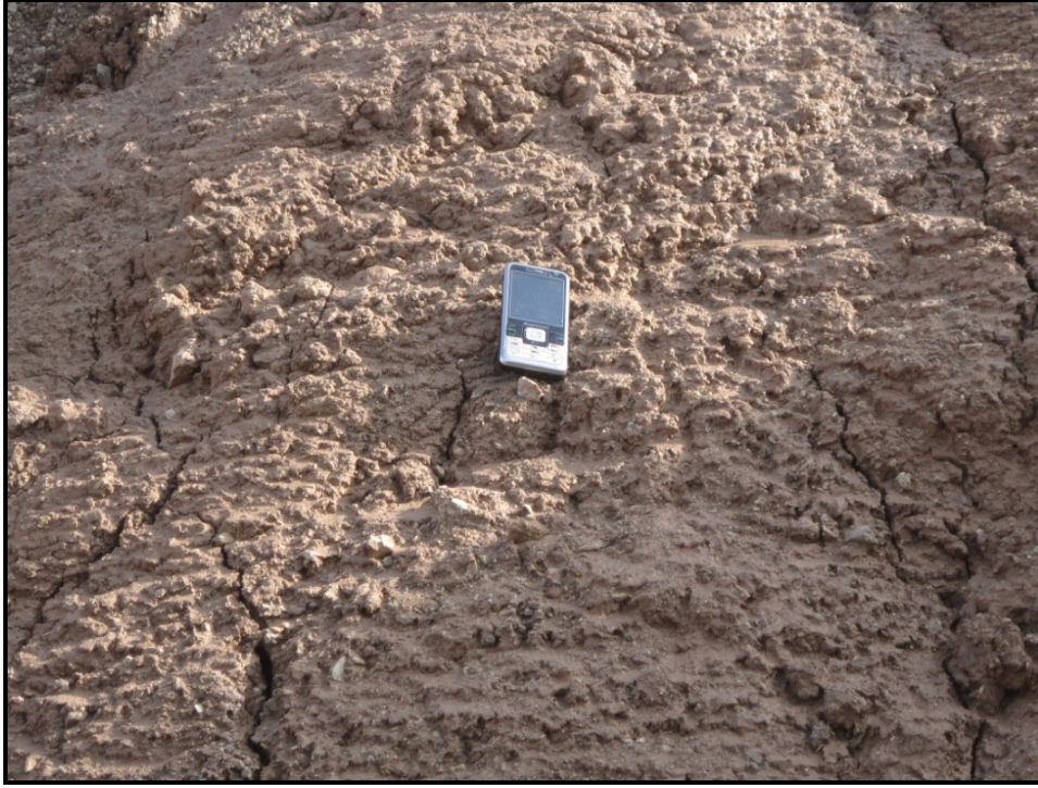
Foto 3: Heyelanın kayma yüzeyinde ortaya çıkan yoğun kil tabakası.
