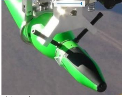
Şekil 1. İki Kanatçıklı 81mm Precision Air-Dropped Guided Mortar (ADM)-General Dynamics [5].
