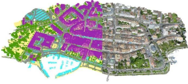
Şekil 15. Pix4DMapper bilgisayar yazılımı kullanılarak birleştirilmiş ve sınıflandırılmış yoğun nokta bulutu görüntüsü (Pix4D, 2018).
