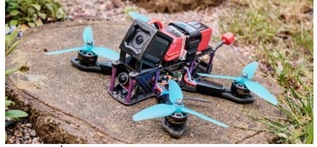
Şekil 47. İHA pilotu tarafından toplanmış ve ayarları yapılmış bir FPV İHA (OscarLiang, 2019).
