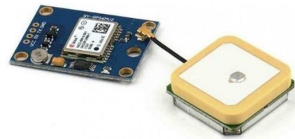
Şekil 6. İHA'larda kullanılan bir GPS modülü (Barbosa vd., 2020)
