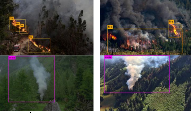
Şekil 18. İHA ile elde edilen görüntüler üzerinde YOLOv3 derin öğrenme algoritmaları kullanılarak yangın bölgesi tespit edilmesi (Jiao vd., 2019).
